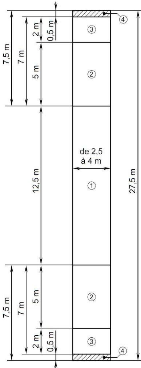
Figure 4 : Dimensions du cadre pour les féminines et pour les épreuves mixtes
