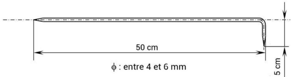
La baguette peut être pliable ou démontable, dotée d'éventuels accessoires, mais les dimensions de la figure 1 doivent être strictement respectées.
